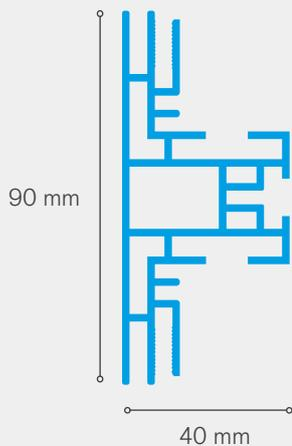
Le DS-90 est un profil en aluminium à double face ayant une épaisseur de 90 mm. Sur la face avant se trouve un bord visible de 1 mm. Les profils ont une couleur standard d'aluminium gris anodisé, blanc Ral 9010 ou noir RAL 9005. d'autre couleurs RAL possibles sur demande.
