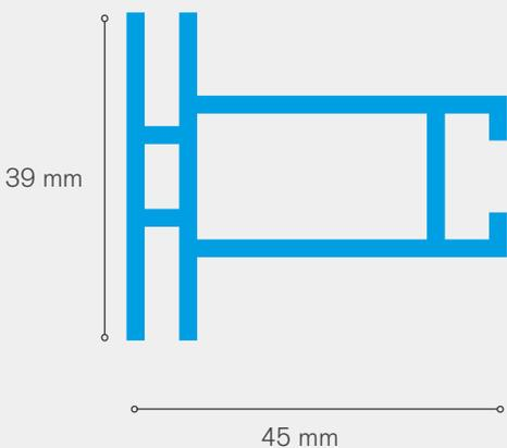
Le DS-39 est un profilé en aluminium double face, basé sur une fenêtre autoportante de 39 x 45 mm, permettant de tendre sur une face une toile imprimée à l'aide d'une bande de silicone (tendon cousu). Ce profilé est fin mais très robuste, ce qui en fait le profilé de choix pour les cadres présentoirs autoportants. Pour les cadres de plus de 2 mètres, des profilés de renforcement supplémentaires sont prévus.
