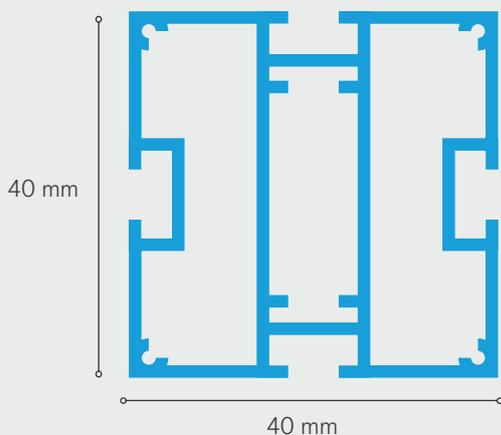
Le SP-40-40 est un profilé de support carré en aluminium de 40 x 40 mm, utilisé pour relier les cadres en position angulaire, le long des 4 côtés de fixation.
